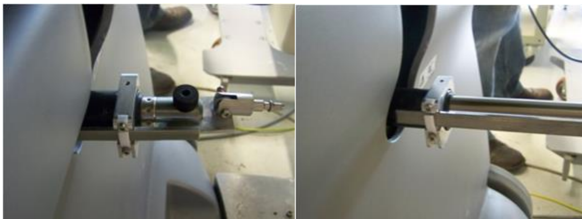
Obr. 80: Akční člen v minimální/maximální poloze
