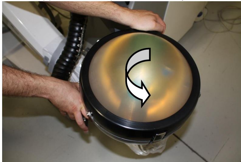
Obr. 70: Otáčení hlavičky z pozice 50° do pozice 0°
