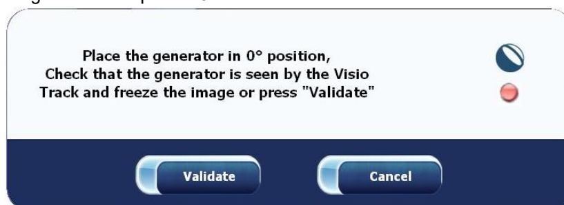
Obr. 107: Kontrola kalibrace systému Visio-Track (0°)
